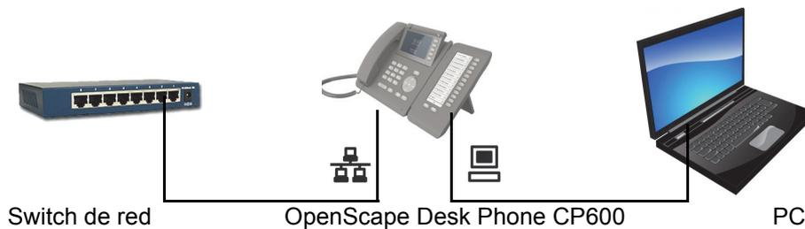
Gracias a este tipo de conexión se evita ocupar una conexión de red en el switch utilizado y los trayectos de cable resultan más cortos.
