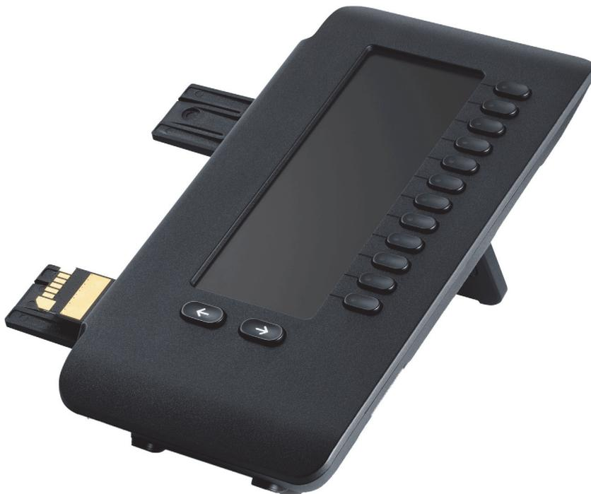
La figura muestra el OpenScape Key Module 600. Puede conectar hasta cuatro OpenScape Key Module 600.
